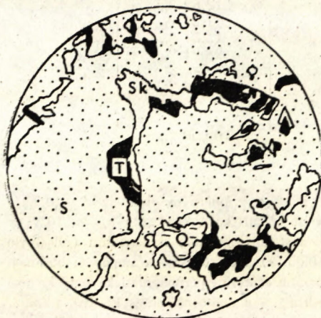
Obr. 1. Skutteruditové (?) ledvinité pásy (bílé) v sideritu (tečkovaný). Tetraedrit (černý) cementuje jejich segmenty a zčásti je zatlačuje. Také křemen sulfidické periody (vodorovné čárky) se jeví jako mladší. Zvětš. asi 200×.
