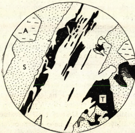
Obr. 3. Cosalit (bílý) zatlačuje výrazně zrna tetraedritu (černý), který sám metasomoval siderit (tečkovaný). Hranice siderit-cosalit v levé části obrázku a arsenopyrit (vodorovné čárky) — cosalit je zřejmě fosilní. Zvětš. asi 200×.
